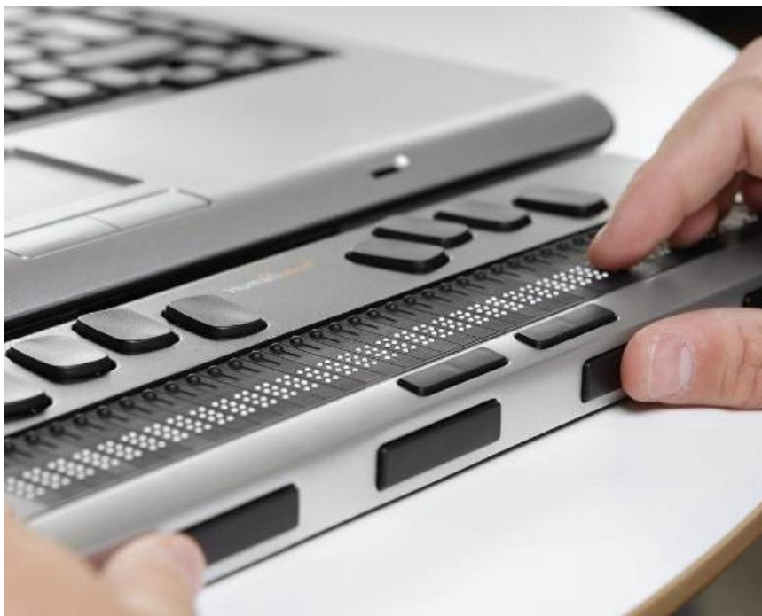
Εικόνα 4: Braille BI 40X, Ανανεώσιμη Οθόνη Μπράιλ 40 χαρακτήρων
