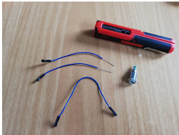
Εικόνα 17: Απογύμνωση καλωδίων για την συγκόλληση τους στα LEDs
