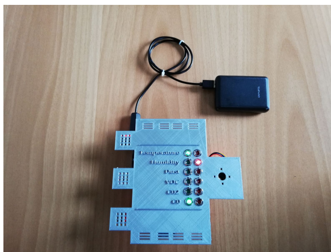
Εικόνα 33: Δοκιμή λειτουργίας του συστήματος για θερμοκρασία, υγρασία και CO
