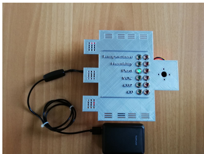
Εικόνα 43: Δοκιμή λειτουργίας του συστήματος για την σκόνη
