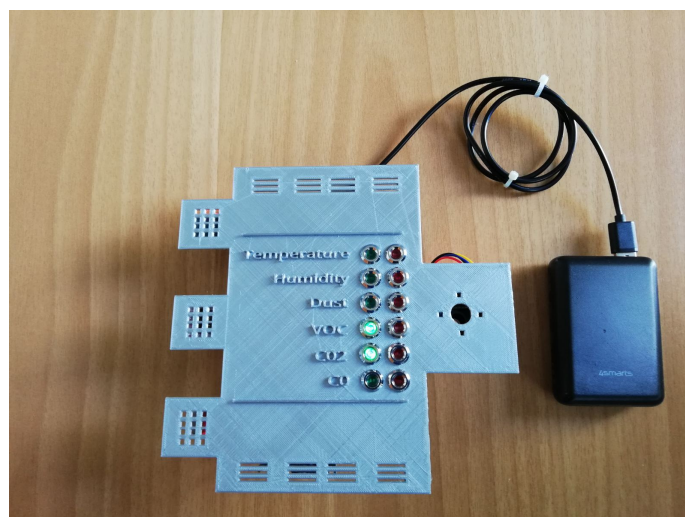
Εικόνα 36: Δοκιμή λειτουργίας του συστήματος για VOC και CO 2
