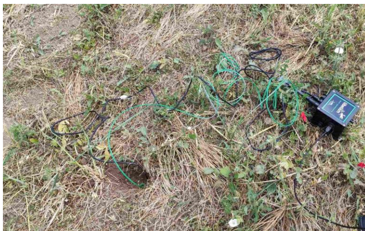
Εικόνα 60: Απεικόνιση τοποθέτησης αισθητήρων
