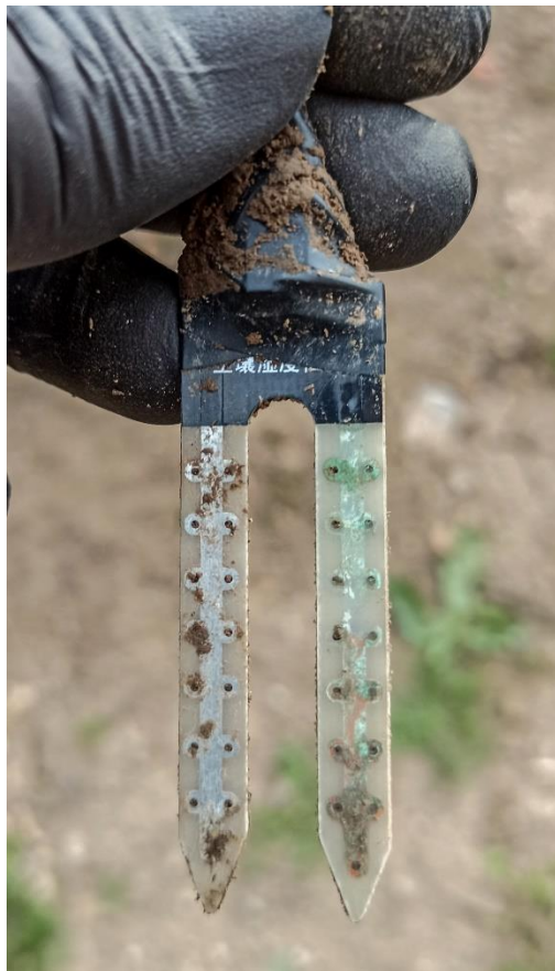
Εικόνα 84: Οξείδωση αισθητήριου YL-69
