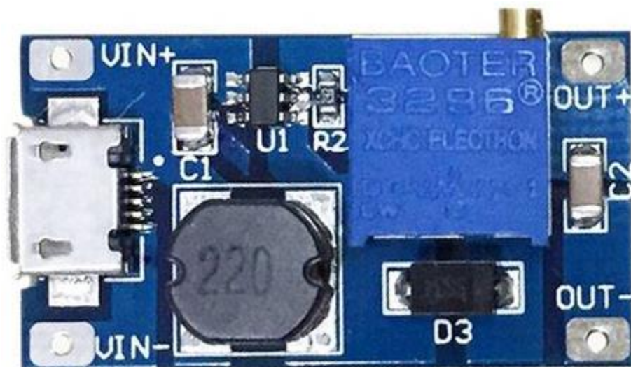
Εικόνα 25: Μετατροπέας step up 2~24 --> 5~28 Volt
