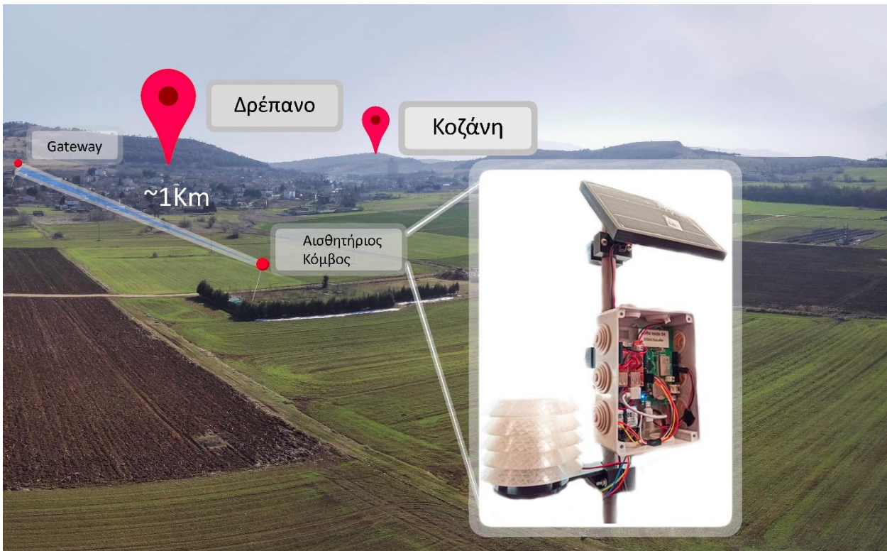
Εικόνα 79: Αισθητήριος κόμβος σε πραγματικές συνθήκες
