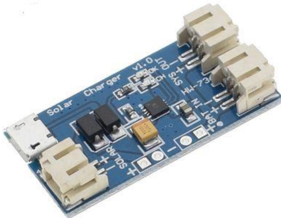
Εικόνα 24: Φορτιστής ηλιακών πάνελ CN3065
