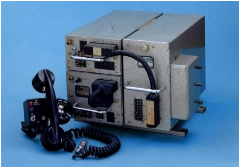
Εικόνα 1 Το πρώτο σύστημα κινητών τηλεφώνων για αυτοκίνητα (USwitch, 2021)
