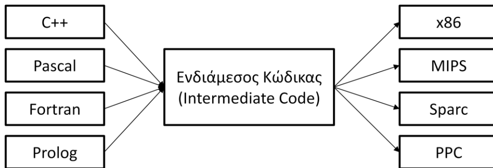
Σχήμα 2.2: Ο κώδικας οποιασδήποτε γλώσσας μεταφράζεται στον ίδιο ενδιάμεσο κώδικα πριν μεταγλωττιστή στην εκάστοτε γλώσσα μηχανής.
