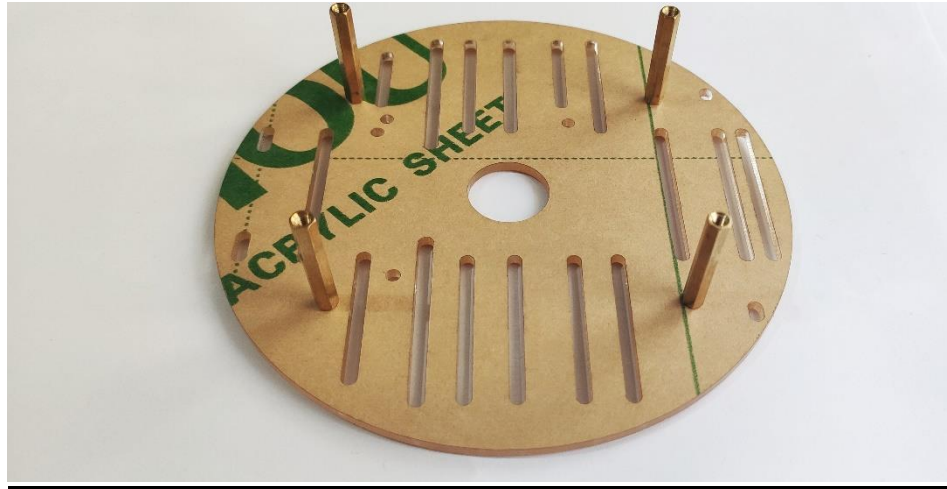
Εικόνα 5.7: Βίδωμα μεγάλων πυλώνων στο κάτω μέρος της κυκλικής πλακέτας.
