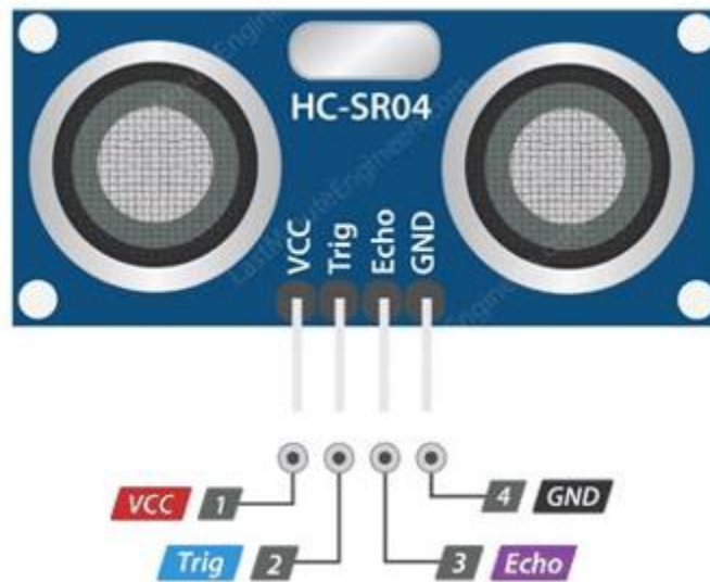
Εικόνα 3.1:Ultrasonic sensor HC-SR04
