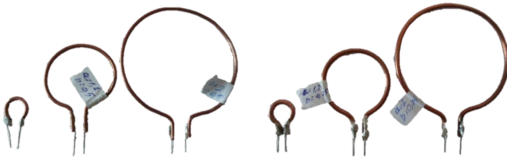
Σχ. 7.3. Οι κεραίες που κατασκευάστηκαν με ακτίνα διατομής 0.5mm και 0.75mm.
