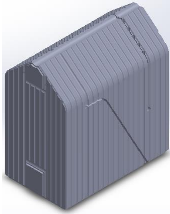
Εικόνα 3.7: Ισομετρική όψη του θαλάμου καύσης, χωρίς σωληνώσεις
