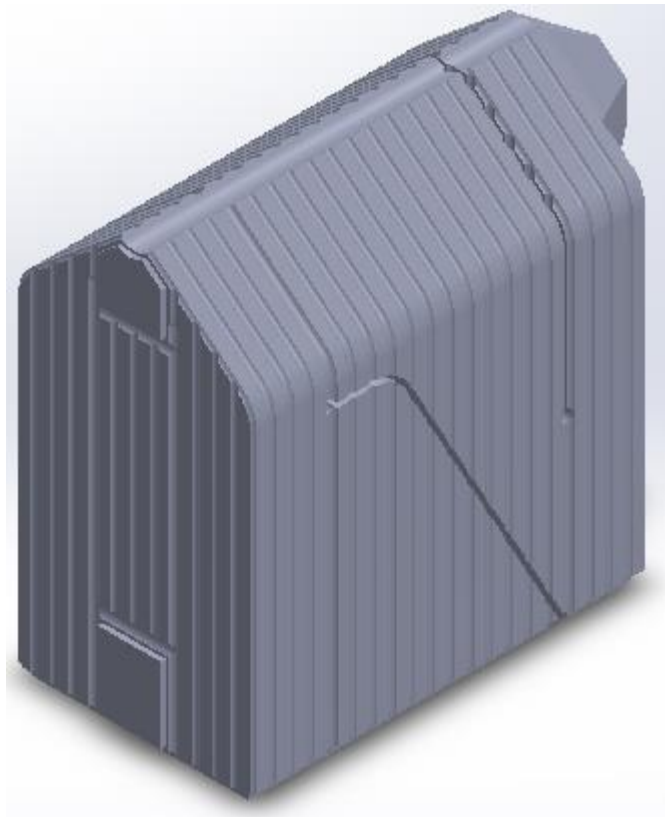
Εικόνα 3.9: Ισομετρική όψη του θαλάμου καύσης με βελτιωμένη γεωμετρία στην έξοδο
