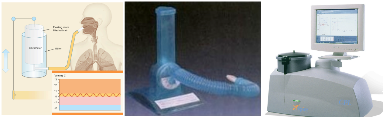
Εικόνα 5.3.1-1: Σχηματική αναπαράσταση λειτουργίας σπυρομέτρου βασισμένο στη μέτρηση όγκου (αριστερά) και δύο υπάρχοντα σπυρομέτρα που χρησιμοποιούν αισθητήρα όγκου για τη λειτουργία τους.
