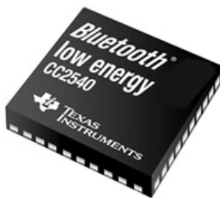
Εικόνα 6.2-1: Texas Instruments CC2540 ολοκληρωμένο τύπου SoC (System on a Chip) το οποίο υποστηρίζει την τέταρτη γενιά του πρωτοκόλλου Bluetooth.
