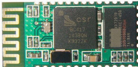
Εικόνα 5.3.3-4: Bluetooth 2.0 EDR module βασισμένο στο CSR BC417143, με ενσωματωμένη κεραία και όλα τα απαραίτητα ηλεκτρονικά.
