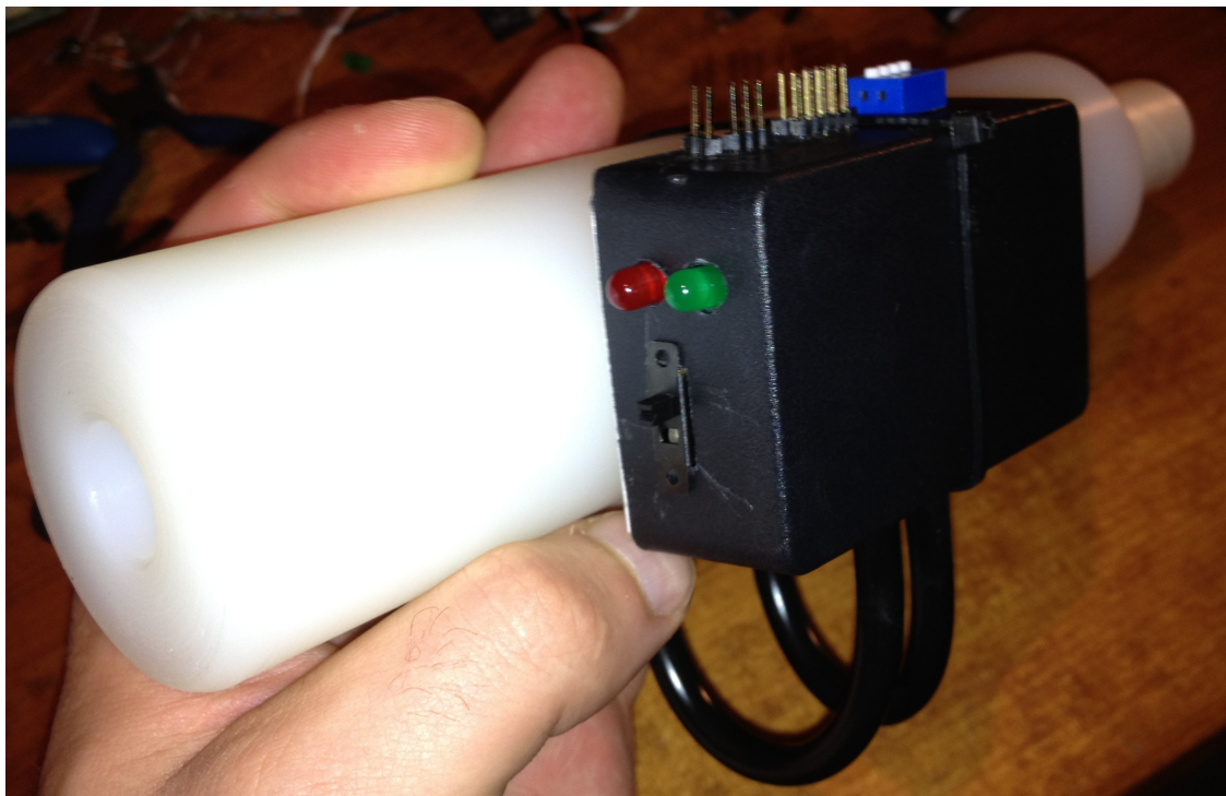
Εικόνα 6.4-2: Το βελτιωμένο, ως προς το μέγεθος και κατανάλωση, νέο πρωτότυπο σπιρόμετρο.
