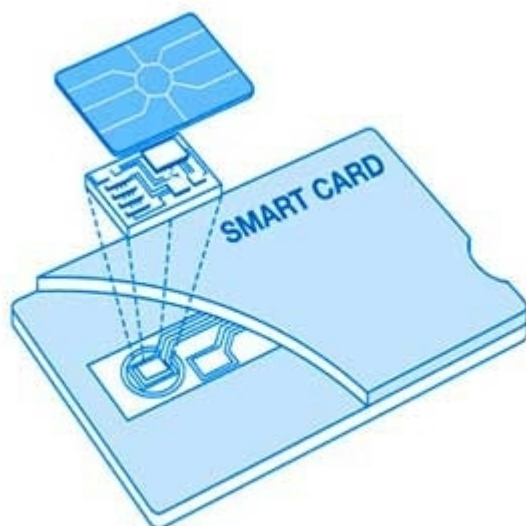
Σχήμα 5.7: Έξυπνη κάρτα με μικροεπεξεργαστή και ηλεκτρικές επαφές
