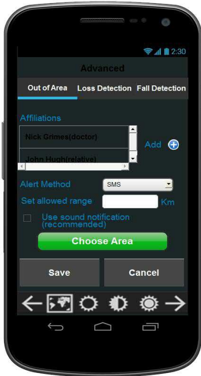
Εικόνα 13: Η οθόνη προχωρημένων ρυθμίσεων της υπηρεσίας Out of Range(Out of Range Advanced Settings). Εμπεριέχει τη λίστα με τα ονόματα των ατόμων που θα ειδοποιηθούν σε περίπτωση συναγερμού και το κουμπί Add, που προσθέτει νέες καταχωρήσεις στη λίστα. Επίσης υπάρχει επιλογή για τη μέθοδο ειδοποίησης (στοιχείο που καταργήθηκε στον τελικό σχεδιασμό), επιλογή της επιτρεπόμενης εμβέλειας και το κουμπί Choose Area(Επιλογή περιοχής) που επιλέγει την αρχική θέση( το σημείο αναφοράς για την εμβέλεια).
