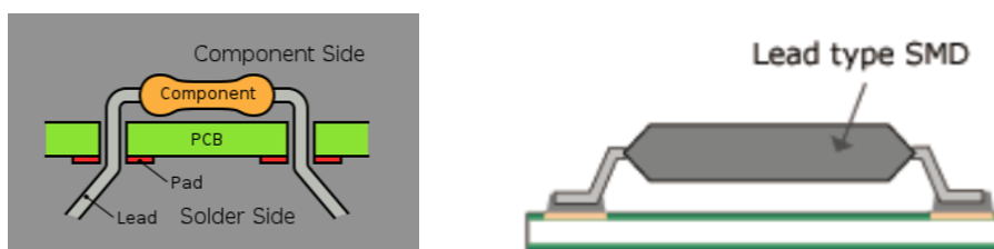
Εικόνα 5-1: Στα αριστερά απεικονίζεται η Through-Hole τεχνολογία ενώ στα δεξιά η SMD
