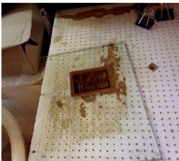
Εικόνα 5-8: Τεχνική φωτολιθογραφίας. Η μάσκα σκιαγραφεί τα μέρη του chip.
