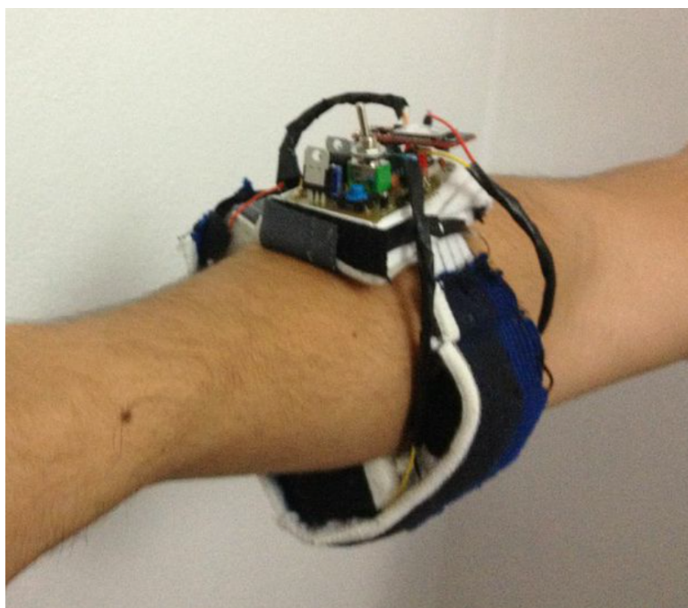
Εικόνα 5-12: Τελική μορφή της συσκευής που αναπτύχθηκε, όπου διακρίνεται ο βραχίονας του χρήστη, το PCB με όλα τα εξαρτήματα και οι ακουστικοί θάλαμοι των μικροφώνων που καλύπτονται από ελαστικό επίδεσμο για λόγους σταθερότητας.
