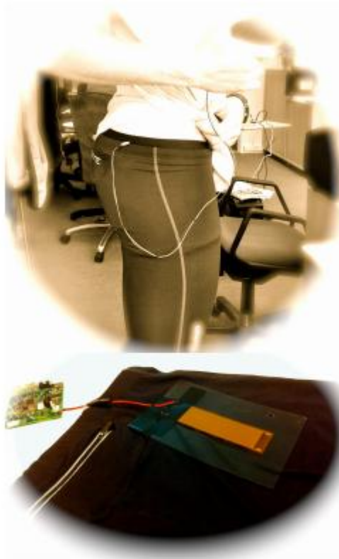
Εικόνα 3.6.1. Τοποθέτηση της MFC συσκευής στην περιοχή των γλουτών. (DELTA, 2011)
