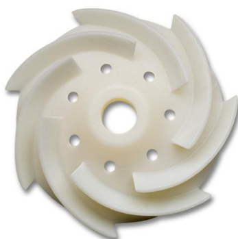
Εικόνα 3.11. Παράδειγμα του πολυμερούς υλικού VeroWhite.
