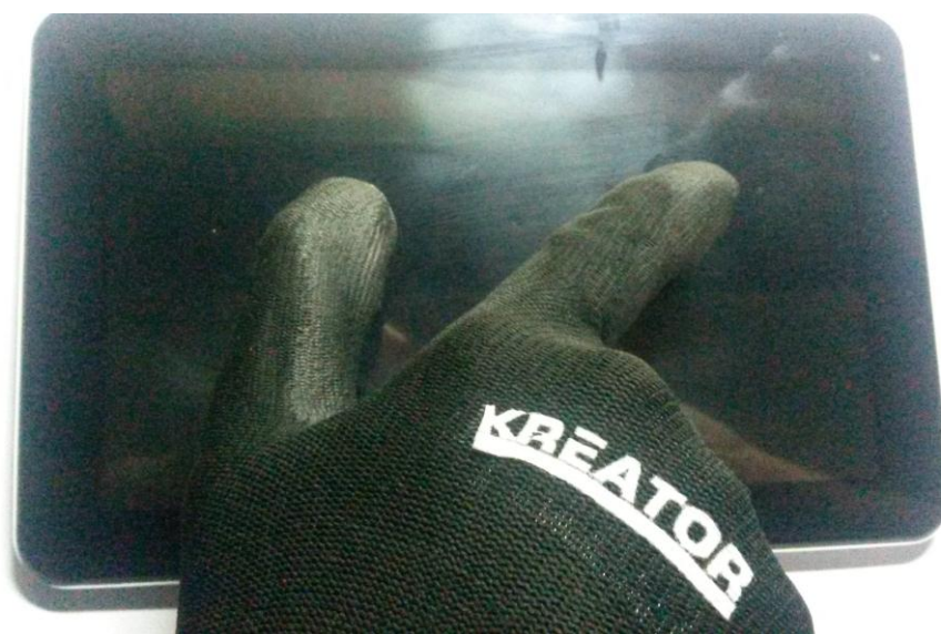
Εικόνα 4.18. Αφή σε tablet χρησιμοποιώντας το πιεζοηλεκτρικό γάντι.
