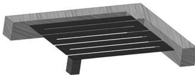
Εικόνα 3.8.3. Η ζιγκ-ζάγκ δομή. (M. Amin Karami and Daniel J. Inman, Applied Physics Letters 100, 2012)
