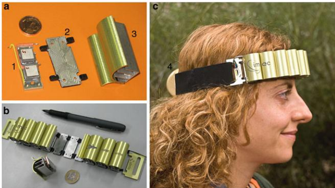
Εικόνα 3.4.1. Ασύρματο σύστημα ηλεκτροκαρδιογραφίας που τροφοδοτείται από την θερμότητα του σώματος: Τα (a) και (b) δείχνουν τα εξαρτήματα της θερμοηλεκτρικής γεννήτριας στο στάδιο της συναρμολόγησης και στο (c) είναι μια ολοκληρωμένη συσκευή. Το (1) είναι μία μονάδα θερμοσωρού (μετατρέπει την θερμική ενέργεια σε ηλεκτρική), το (2) είναι μια θερμή πλάκα, το (3) είναι ένα θερμαντικό σώμα και το (4) είναι η μονάδα ηλεκτρονικών. (Vladimir Leonov, Smart Systems and Energy Technology Imec, Chapter 2, 2011)
