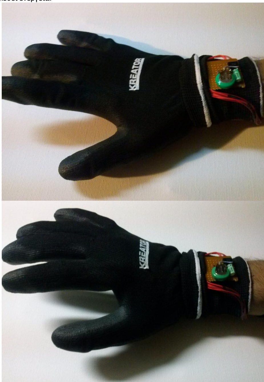
Εικόνα 4.12. Εφαρμοσμένη στο χέρι η ολοκληρωμένη εφαρμογή του πιεζοηλεκτρικού γαντιού.
