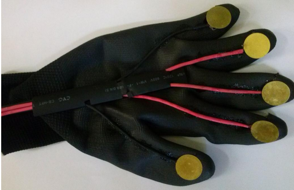
Εικόνα 4.10. Εφαρμογή των πέντε πιεζοηλεκτρικών κρυστάλλων στο γάντι.
