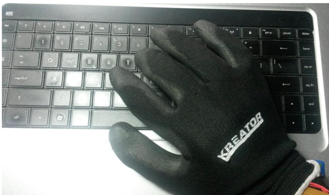
Εικόνα 4.17.2. Πληκτρολόγηση σε laptop χρησιμοποιώντας το πιεζοηλεκτρικό γάντι.
