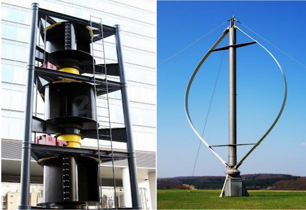
Εικόνες 3.2-3.3: Στην αριστερή εικόνα ένα σύστημα με πολλαπλές ανεμογεννήτριες τύπου Savonius και στην δεξιά εικόνα ανεμογεννήτρια Darrieus μεγάλου μεγέθους .
