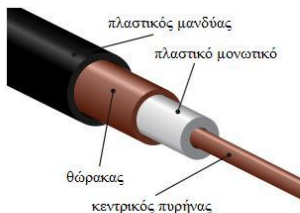
Εικόνα 4.1: Η δομή του ομοαξονικού καλωδίου. (Η εικόνα είναι από την ιστοσελίδα http://en.wikipedia.org/wiki/Coaxial_cable )
