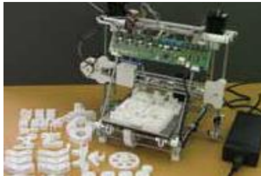
Σχ.3. Τρισδιάστατος εκτυπωτής ο οποίος τυπώνει τα δικά του μέρη
