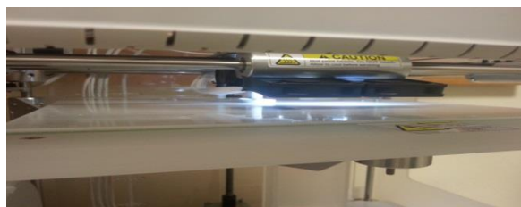
Σχήμα 74. Όταν ο εκτυπωτής αρχίζει να ψεκάζει πάνω στην πλακέτα εκτύπωσης
