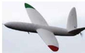
Σχ.5. Το 3D-τυπωμένο αεροσκάφος από το πανεπιστήμιο του Southampton
