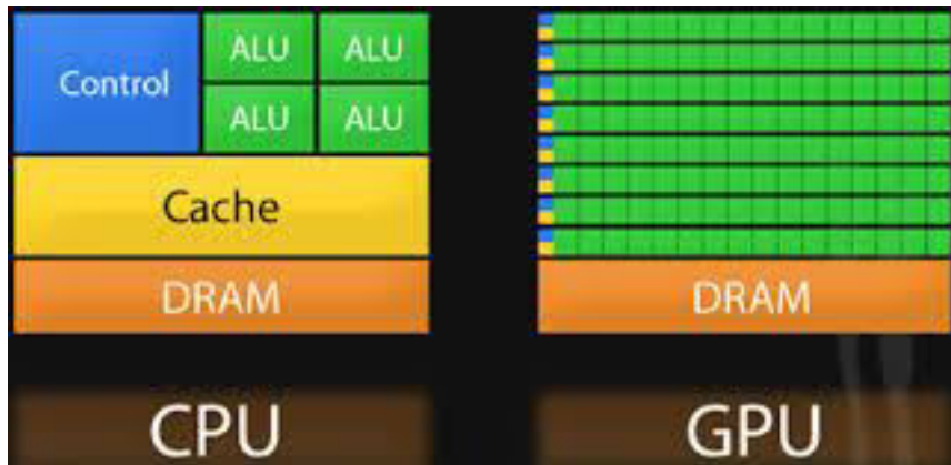
Εικόνα 2.5: Σύγκριση αρχιτεκτονικών CPU και GPU [31].
