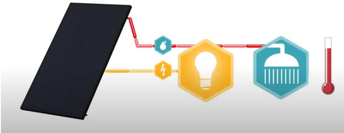
Εικόνα 23: Υβριδικός ηλιακός συλλέκτης για παραγωγή ηλεκτρισμού και ζεστού νερού χρήσης. [18]
