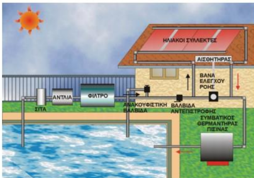
Εικόνα 17: Θερμικό ηλιακό σύστημα θέρμανσης πισίνας. [1]
