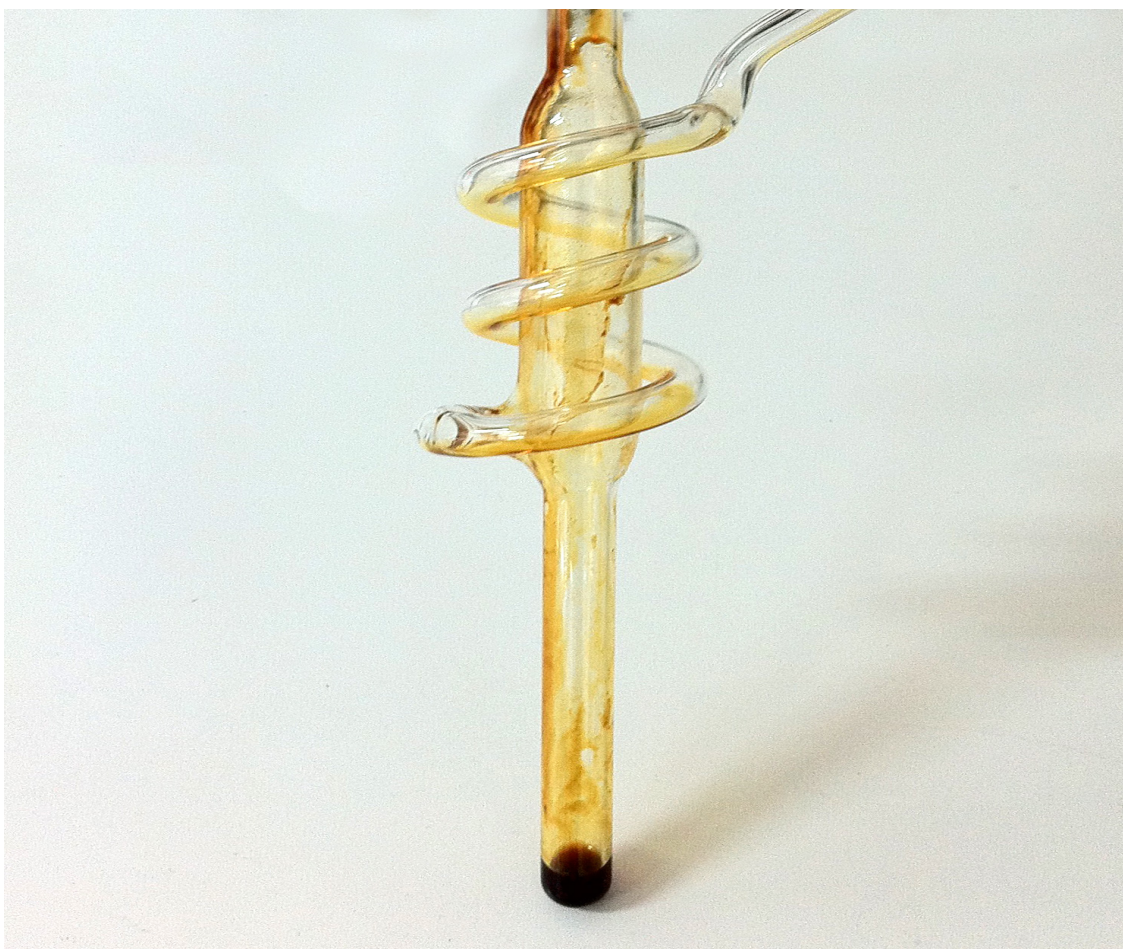
Σχήμα 2.2. Φωτογραφία βιοελαίου που έχει σχηματιστεί στη γυάλινη παγίδα της εργαστηριακής κλίμακας μονάδας πυρόλυσης σταθερής κλίνης. Διακρίνεται η οργανική φάση του βιοελαίου στον πυθμένα και οι ιζώδεις οργανικές επικαθίσεις στα τοιχώματα.
