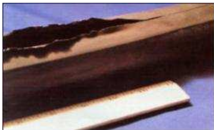
Εικόνα 9-12 : Μηχανική διάβρωση σε αυλό
