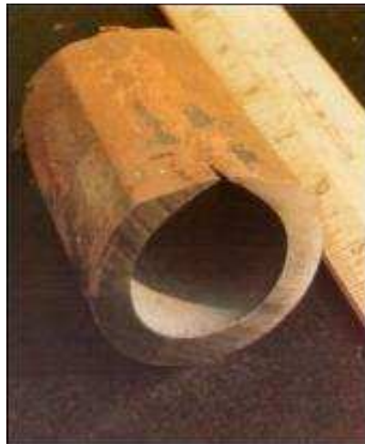
Εικόνα 9-11 : Μηχανική διάβρωση σε αυλό
