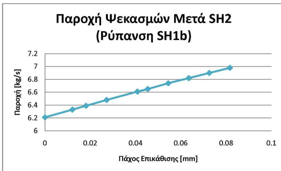
Διάγραμμα 14-26: Επίδραση ρύπανσης του SH1b στην παροχή ψεκασμών μετά SH2
