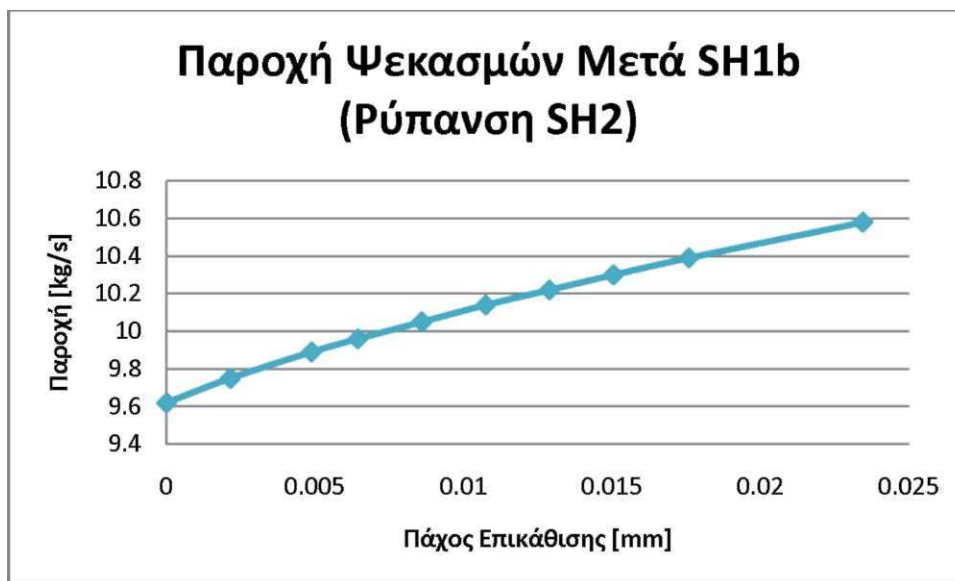
Διάγραμμα 14-40: Επίδραση ρύπανσης του SH2 στην παροχή ψεκασμών μετά SH1b
