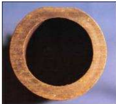
Εικόνα 9-2 : Χημική διάβρωση σε Αυλό (2)
