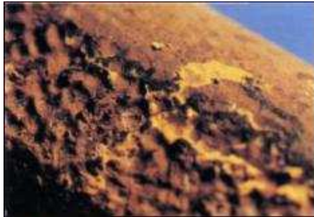
Εικόνα 9-1 : Χημική διάβρωση σε Αυλό (1)
