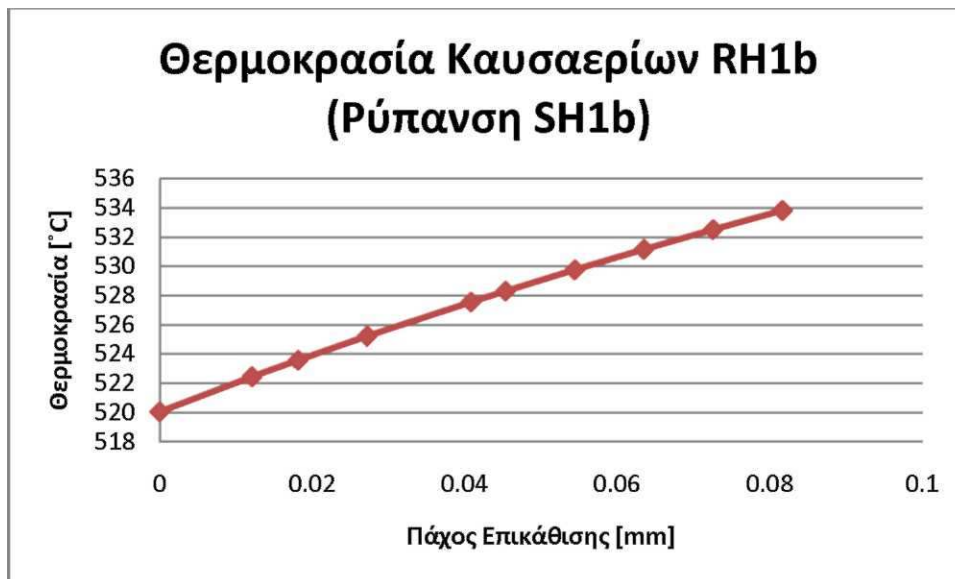
Διάγραμμα 14-23: Επίδραση ρύπανσης του SH1b στον RH1b (Καυσαέρια)
