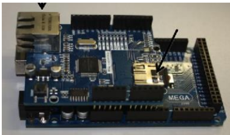
3.9 Τοποθέτηση πλακέτας ethernet στον Arduino atmega2560
