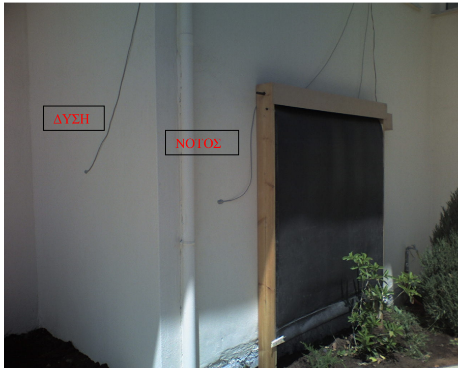
Σχήμα 8.4: Τοποθέτηση εξωτερικών αισθητήρων για την μέτρηση της θερμοκρασίας τοίχου σε δύο διαφορετικούς προσανατολισμούς.
