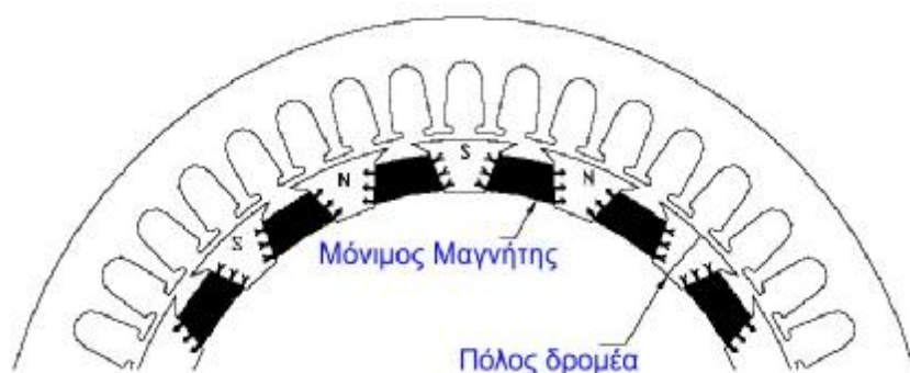
ΕΙΚΟΝΑ 2-9: Συμβατική σύγχρονη μηχανή M.M., με συγκέντρωση ροής (flux concentration)
