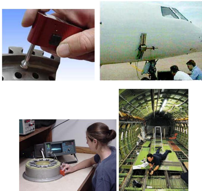
Εικόνα 3.11. Εφαρμογές ελέγχου με τη μέθοδο των δινορρευμάτων στα αεροσκάφη (Rao 2013).
