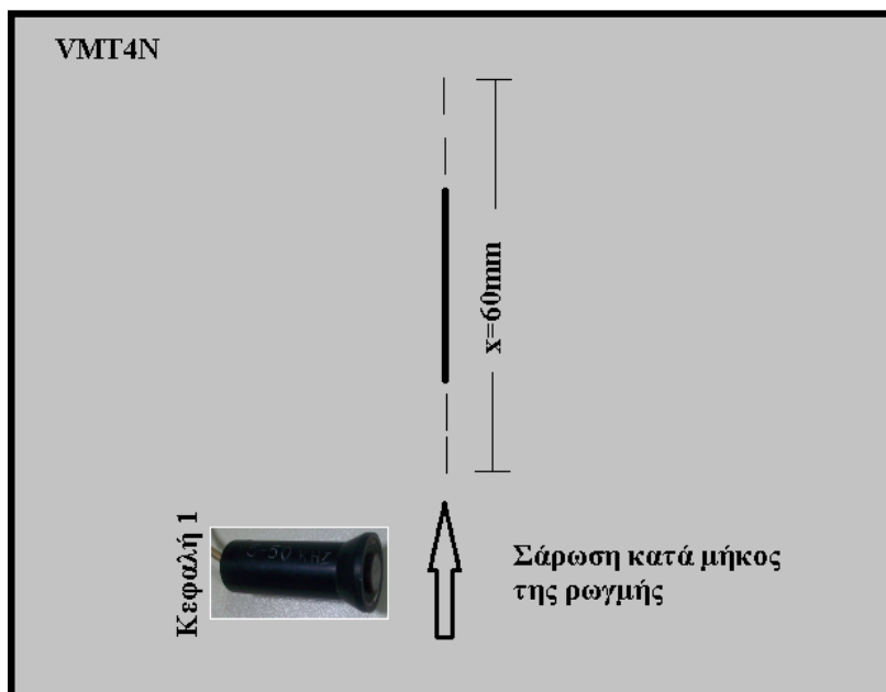
Εικόνα 7.2.5. Σάρωση κατά μήκος της ρωγμής της πλάκας VMT4N, Κεφαλή 1.
