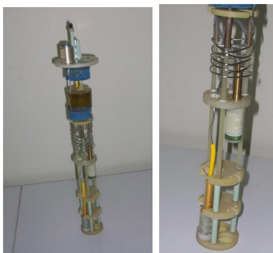
Εικόνα 5.2. Βαθμιδόμετρο SQUID με δύο πηνία λήψης.
