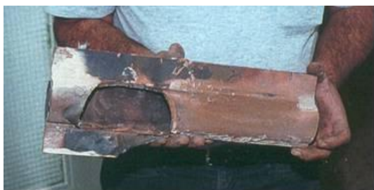
Εικόνα 9 - διαβρωμένο τμήμα αυλού οροφής στα +41 m
