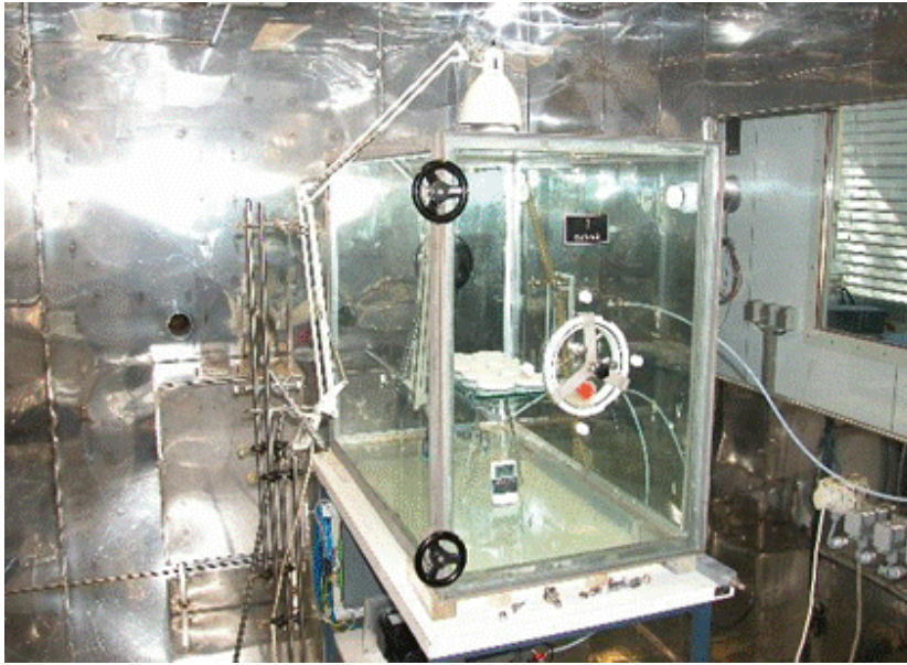
Εικόνα 7.1.2. Περιβαλλοντικός θάλαμος 0.45 \text{ m}^3 στον οποίο πραγματοποιήθηκαν τα πειράματα εργαστηριακής κλίμακας
