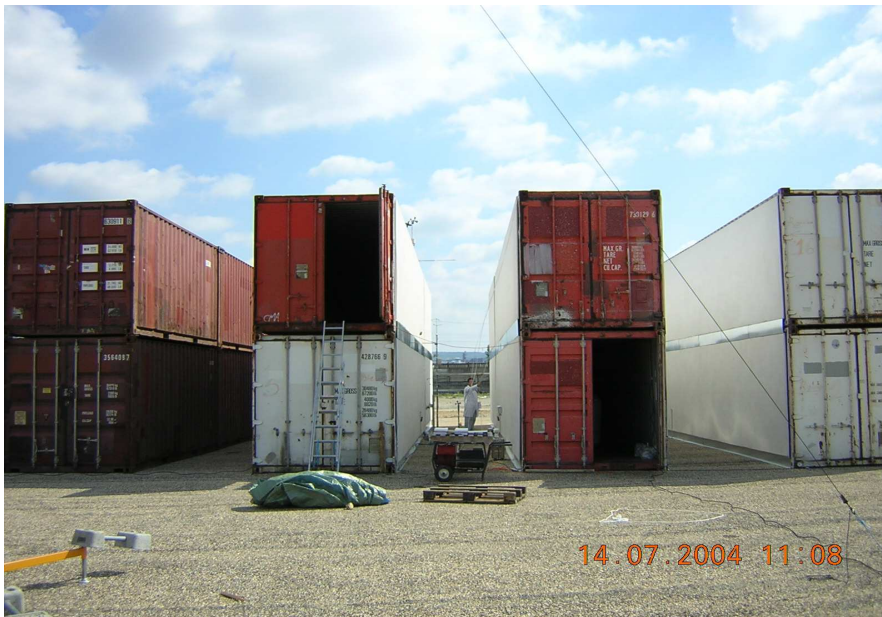
Εικόνα 9.1.1 α, β Πιλοτικό πεδίο αποτελούμενο από 3αστικές χαράδρες (κλίμακα. 1:5)
