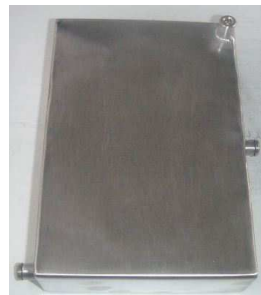
Σχήμα 7-45: Διάταξη δεξαμενής για αποθήκευση υδρογόνου.
