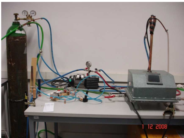
Σχήμα 7-1: Σύστημα τήξης με βολταϊκό τόξο.
