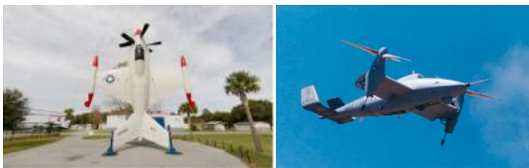
(a) (b) Εικόνα 1.7: (a) Lockheed XFV-1 tail-sitter, (b) Bell eagle eye convertiplane Πηγή: [4]
