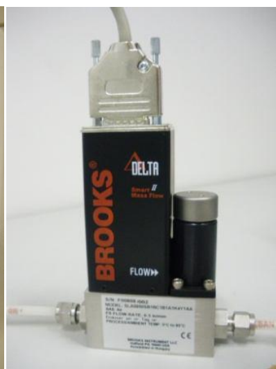
Εικόνα 16: Mass flow controller (έλεγχος ροής του αέρα που διαβιβάζεται στο CLIMPAQ) DELTA BROOKS©(δεξιά), ρυθμιστής του mass flow controller (αριστερά).
