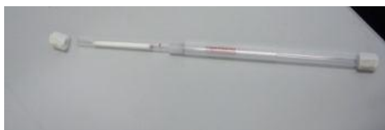
Εικόνα 19: Σωληνάκι δειγματοληψίας VOC με προσροφητικό υλικό Tenax TA®: Χρησιμοποιείται για την δέσμευση πτητικών και ημιπτητικών οργανικών ενώσεων.
