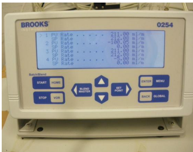
Εικόνα 16: Mass flow controller (έλεγχος ροής του αέρα που διαβιβάζεται στο CLIMPAQ) DELTA BROOKS©(δεξιά), ρυθμιστής του mass flow controller (αριστερά).
