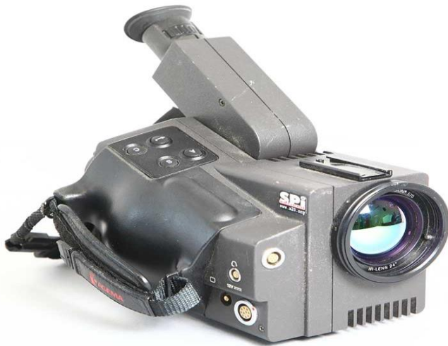
Σχήμα 13: Κάμερα υπέρυθρης ακτινοβολίας AGEMA 570.
