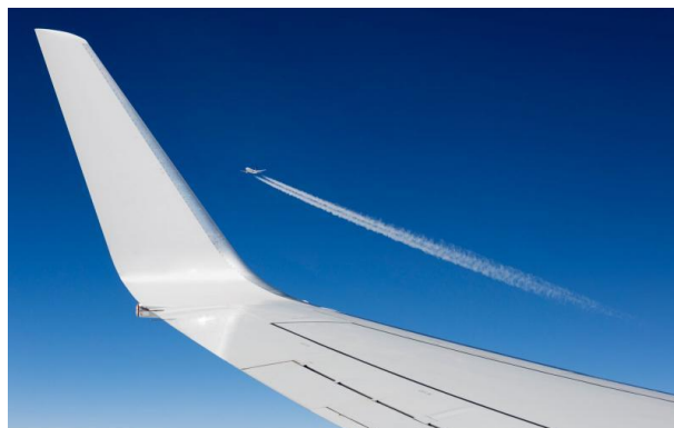
Εικόνα 2.10: Εφαρμογή φράκτη ακροπτερυγίου σε πτερύγιο αεροπλάνου
