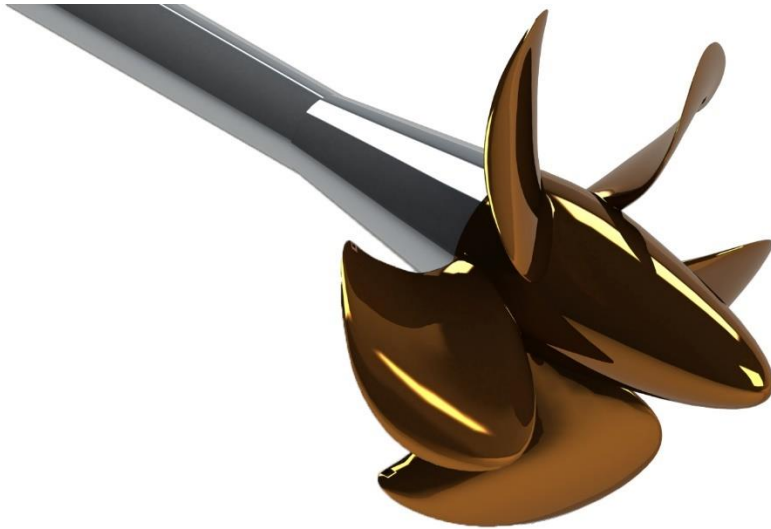
Σχήμα 3.3: Η τελική προπέλα. Το μπρονζέ κομμάτι περιστρέφεται και το ασημί μένει ακίνητο.
