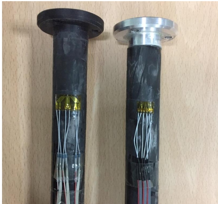
Σχήμα 5.7 : Απεικόνιση τοποθέτησης αισθητήρων παραμόρφωσης (strain gauges)
