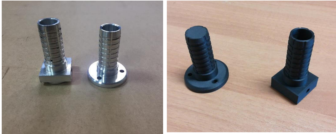
Σχήμα 3.8: Σύνδεσμοι 1 και 2 από αλουμίνιο και carbon
