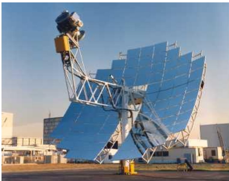
Εικόνα 2.13 Συγκεντρωτικός συλλέκτης σημειακής εστίασης. Πηγή: (Hanania, etal. 2018)
