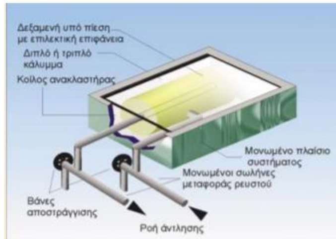
Εικόνα 2.6 Τομή συμπαγούς θερμαντήρα νερού. Πηγή: (Κ.Α.Π.Ε. 2000)
