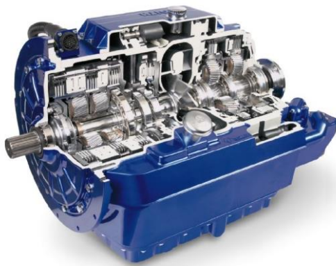
Σχήμα 1.3: Κιβώτιο ταχυτήτων DIWA 5 (πηγή: www.voith.com ).
