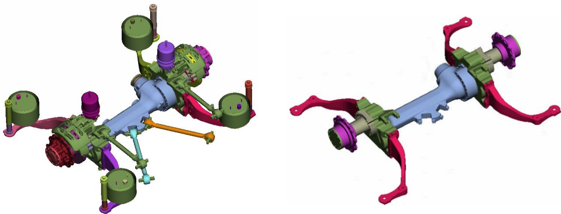
Σχήμα 2.7: Αριστερά παρουσιάζεται το αρχικό σχέδιο του άξονα, μη συμπεριλαμβανομένων των ζαντών και των ελαστικών, ενώ στα δεξιά ο άξονας μετά την απλοποίηση.
