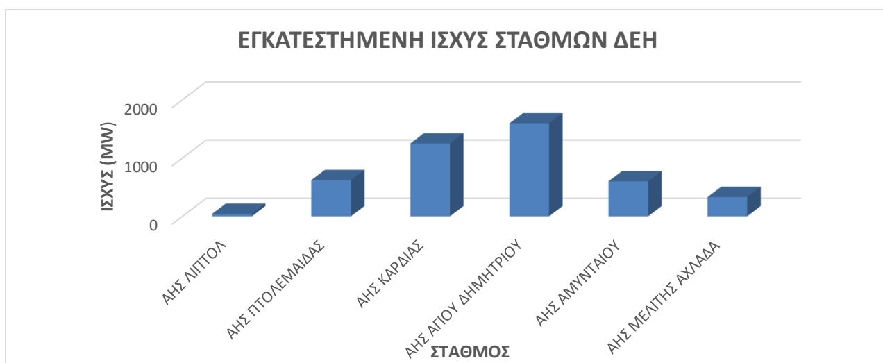
Διάγραμμα 2: Γραφική απεικόνιση εγκατεστημένης ισχύς των έξι λιγνιτοπαραγωγικών σταθμών της περιοχής Κοζάνης-Φλώρινας
