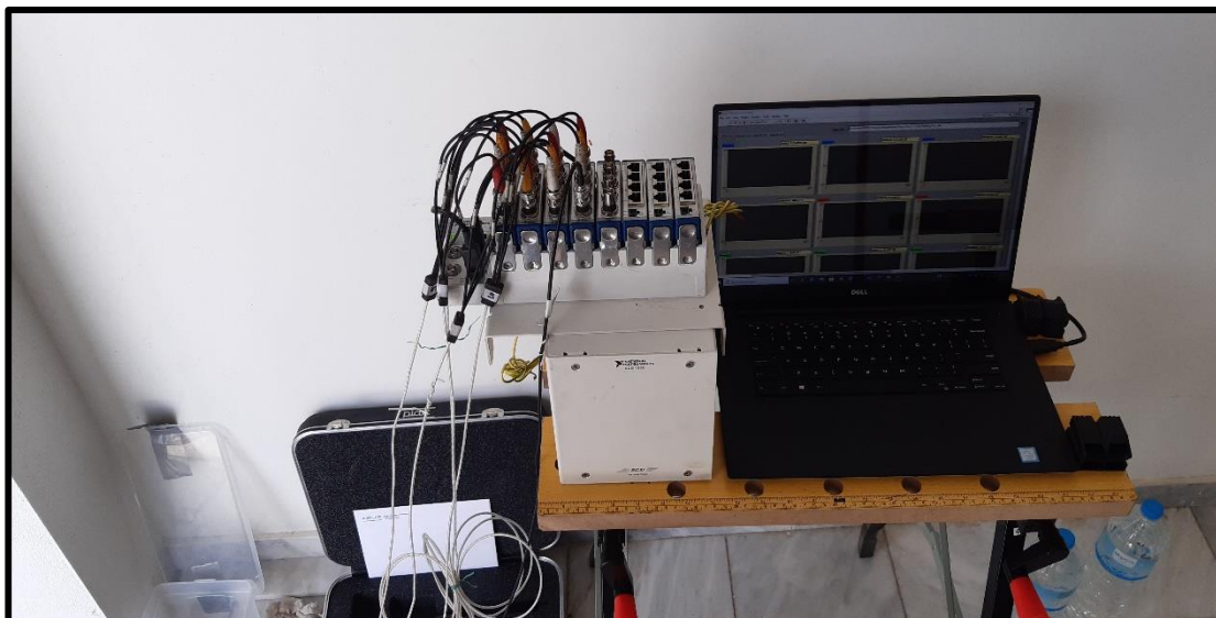
Εικόνα 5.19: Σύστημα συλλογής δεδομένων με χρήση του λογισμικού Labview
