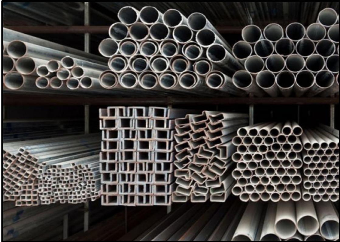
Εικόνα 2.2: Διάφορες διατομές χάλυβα
