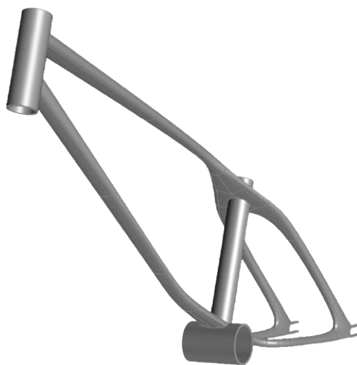
Εικόνα 6.7 Σχεδίαση πλαισίου ύστερα από την τροποποίηση των πεπλατυσμένων τμημάτων
