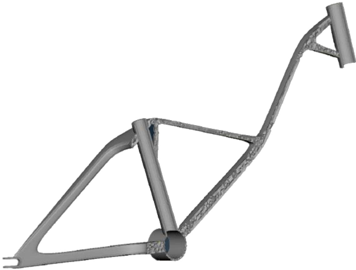
Εικόνα 5.14 Διακριτοποίηση των όγκων του πλαισίου
