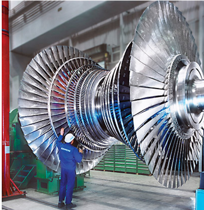
Εικόνα 5.2. Ρότορας συμμετρικού ατμοστροβίλου χαμηλής πίεσης στο Muelheim με 7 βαθμίδες σε κάθε μεριά
