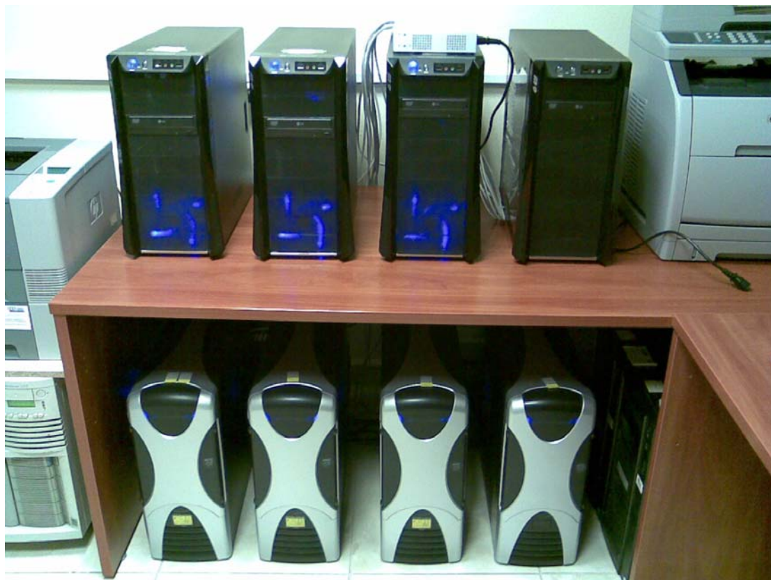
Εικόνα Δ.1. Αυτοσχέδια συστοιχία (cluster) υπολογιστών
