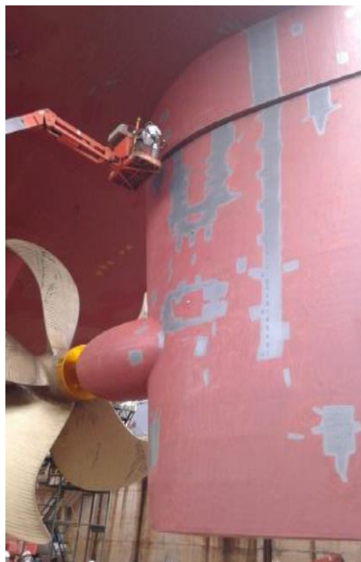
Εικόνα 26: Προσθήκη βολβού για υδροδυναμική βελτίωση του πηδαλίου
