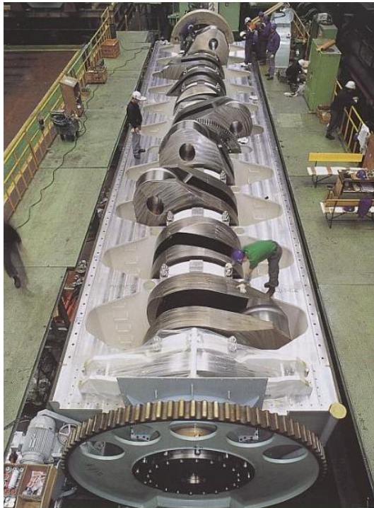
Εικόνα 22: Σφόνδυλος μόλις τοποθετημένος σε στροφαλοφόρο άξονα σε νεόκτιστη μηχανή (Προσωπικό αρχείο)
