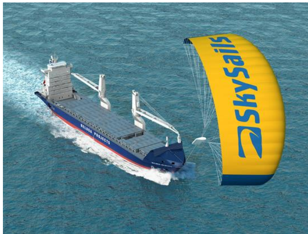
Εικόνα 31: Χρήση χαρταετού για την πρόωση πλοίου
