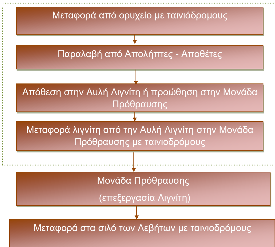
Εικόνα 5 Διαδικασία παραλαβής, αποθήκευσης και πρόθραυσης λιγνίτη[2]
