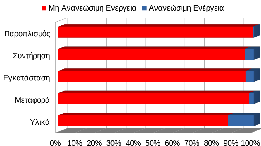
Σχήμα 23. Απεικονίζεται το ποσοστό της ενέργειας (ανανεώσιμης και μη ανανεώσιμης) που δαπανήθηκε σε κάθε στάδιο του κύκλου ζωής, του αιολικού πάρκου της Αλεξανδρούπολης.
