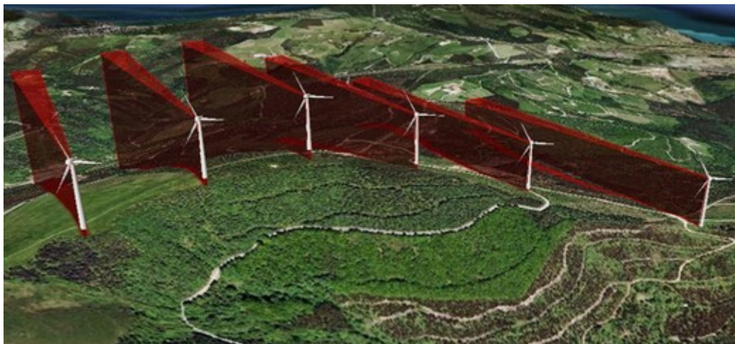
Εικόνα 18. Ο φραγμός του σήματος (κόκκινο χρώμα) που προκαλείται στο πίσω μέρος της ανεμογεννήτριας. Πηγή: Angulo et al., 2014.
