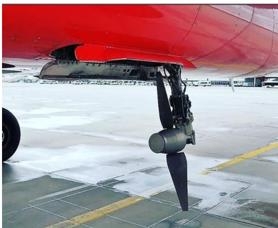
Σχήμα 2 Εφεδρικό σύστημα ανάκτησης ενέργειας
