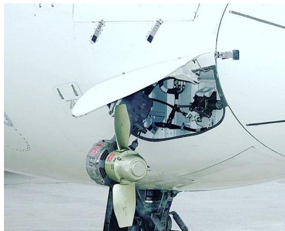
Σχήμα 1 Εφεδρικό σύστημα ανάκτησης ενέργειας
