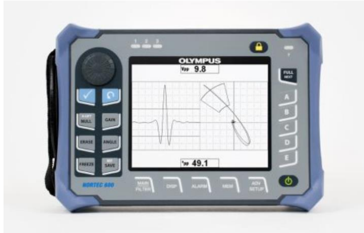
Εικόνα 22. Όργανο δινορρευμάτων NORTEC 600 (Πηγή: www.olympus-ims.com ).
