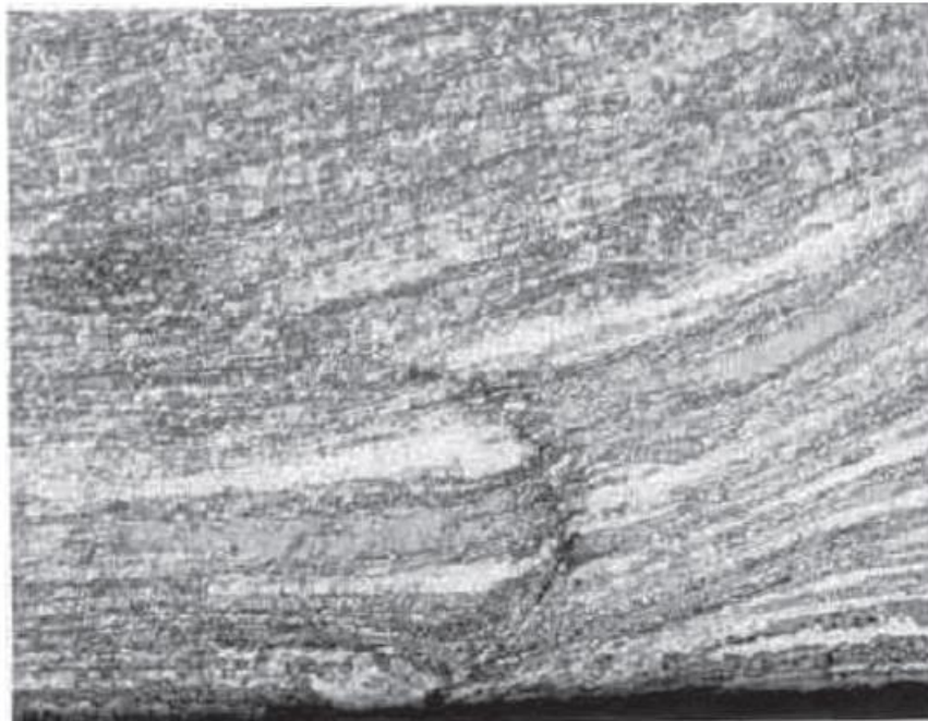
Εικόνα 9. Οπτική μικρογραφία που απεικονίζει μια ατέλεια τύπου φιλιού (Kissing bond) [8].
