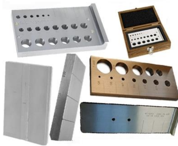
Εικόνα 23. Παραδείγματα πρότυπων δοκιμίων μη-καταστροφικού ελέγχου μέσω δινορρευμάτων (Πηγή: nde-solutions.com ).
