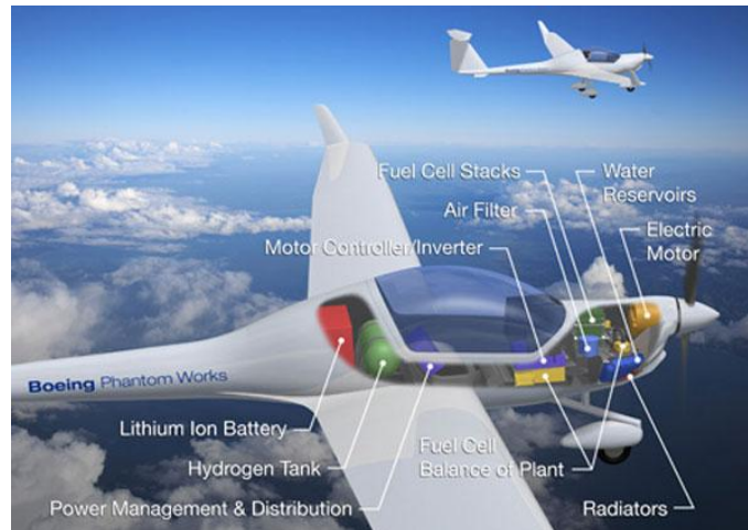
Σχήμα 2-14: Σχεδιαζόμενο πτητικό μέσο με χρήση PEM κυψέλης καυσίμου (πηγή: http://www.whnet.com/4x4/fuelcell.html )
