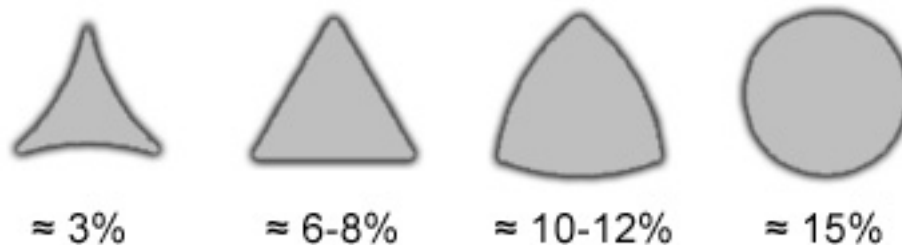
Σχήμα 4-5: Διατομή των συνδέσμων ( ligaments ) για μεταλλικούς αφρούς ανοικτού κελιού με πορώδες \epsilon = 97\% , 94-92% , 90-88% και 85% αντίστοιχα, ( ERG )
