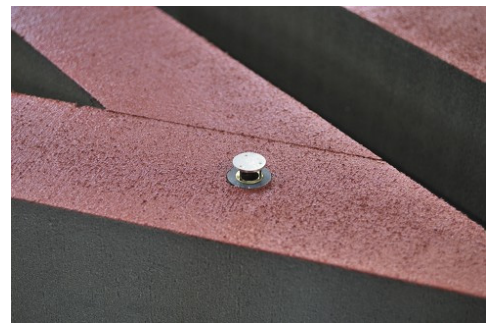
Σχήμα 10.18. Η πηγή του ρύπου στο πείραμα από κοντά. Βρίσκεται στο κτίριο «J» (πηγή: EWTL, Πανεπιστήμιο Αμβούργου).
