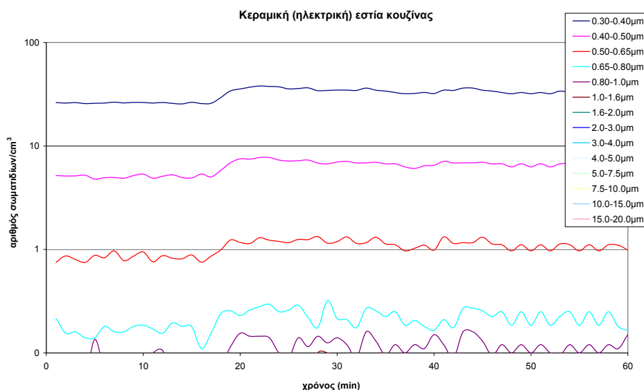
Σχήμα 4.4.7α: Συγκέντρωση αριθμού των σωματιδίων/cm 3 σε 14 κανάλια μεγέθους 0.30-20.0 μm για τη λειτουργία της ηλεκτρικής εστίας.
