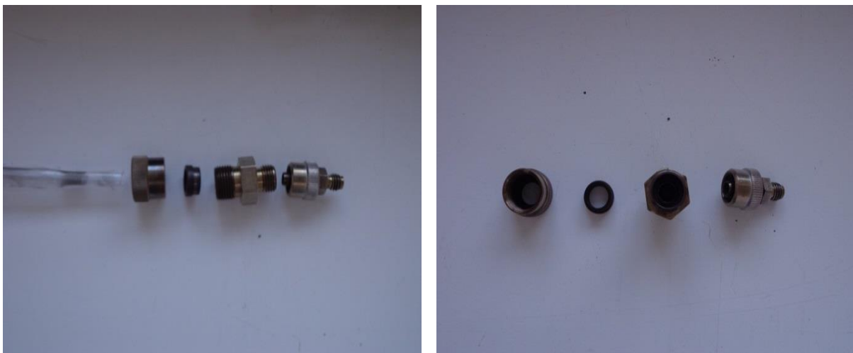
Σχήμα 5.3: Φωτογραφία καταλυτικού αντιδραστήρα από χαλαζία και συστήματος Ultra-Torr.
