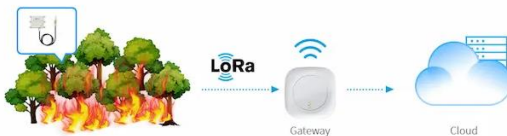
Εικόνα 8. Διαγραμματική απεικόνιση συστήματος πυρανίχνευσης IoT
