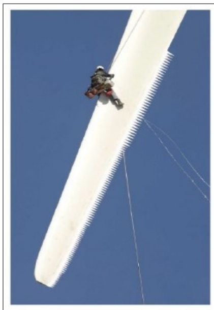
Σχήμα 3.2.3.2.2: Πτερύγιο ανεμογεννήτριας με οδοντωτές προσθήκες στην ακμή φυγής στις έρευνες των Oerlemans et al [41] .
