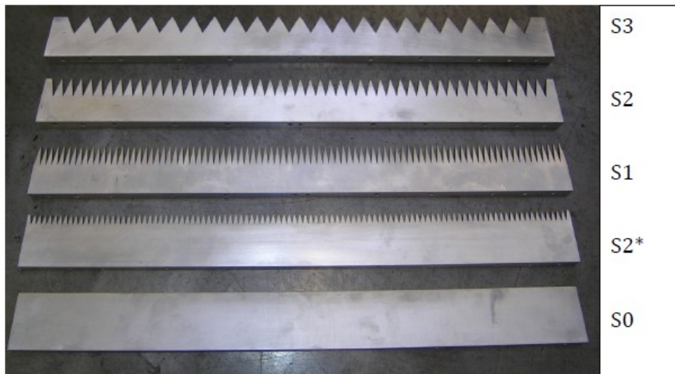
Σχήμα 5.3.2: Γεωμετρία των ακμών φυγής που χρησιμοποιήθηκαν στα πειράματα του Alexandros Vathylakis [53].
